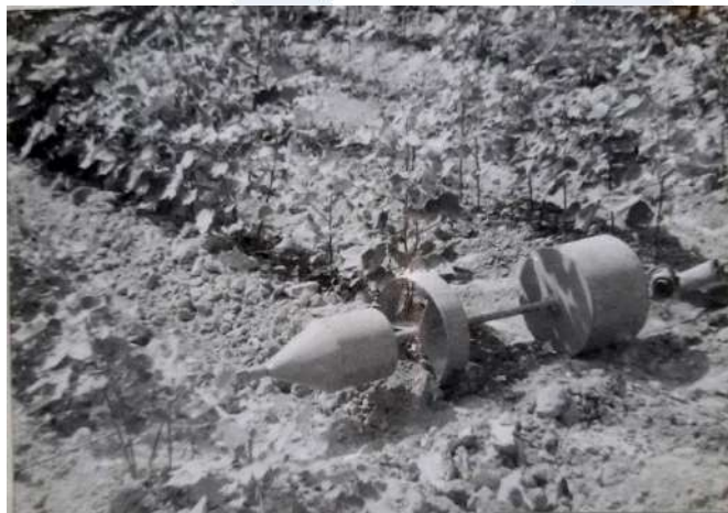
Рис.2. Ложеобразователь для гибкого поливного трубопровода
