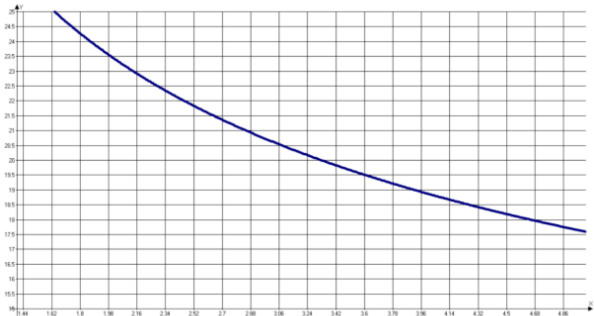
Рисунок 5. График зависимости производительности от отношения H 2 /CO
