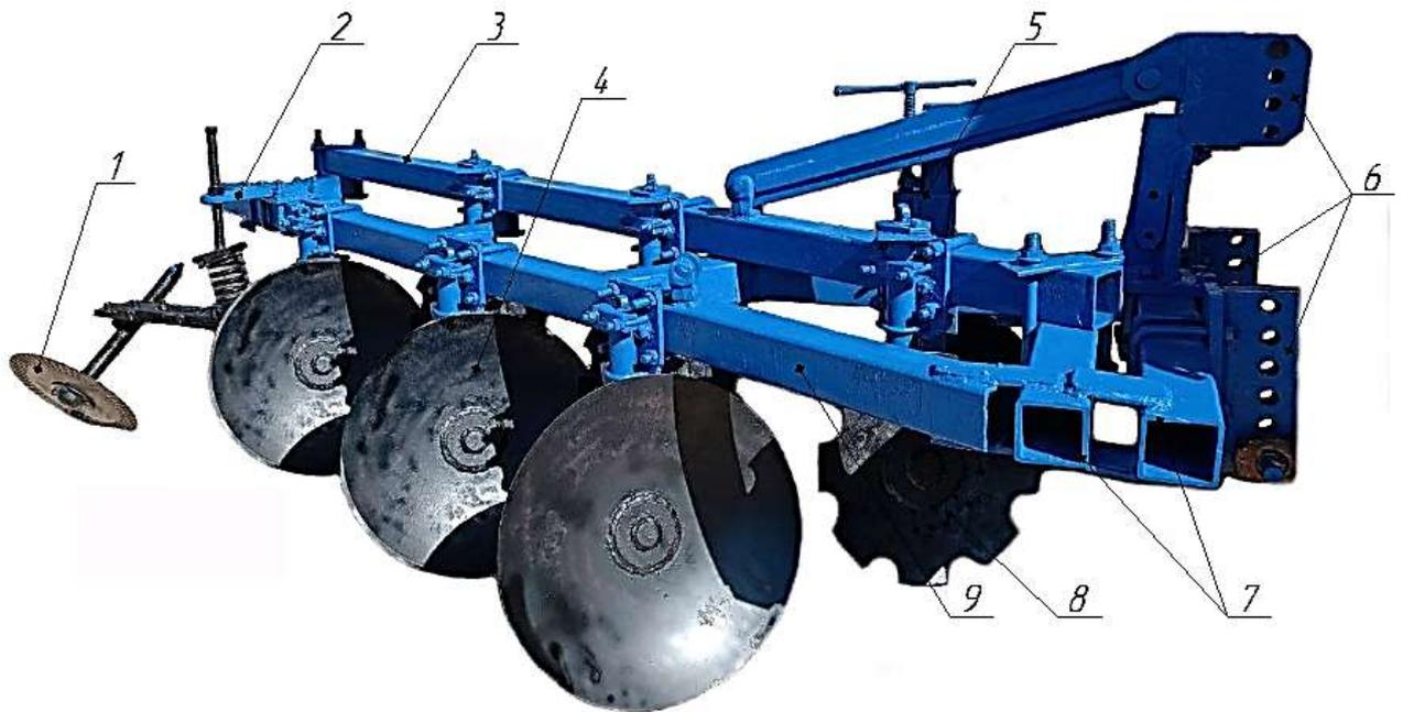
1 - опорное колесо; 2 - заднее опорное устройство; 3 – продольный брус; 4 – Нижний основной дисковый кожух; 5 – механизм регулировки опорного колеса; 6 – подвесное устройство; 7 – продольные брусы; 8 – верхний дисковый кожух; 9-рама.
