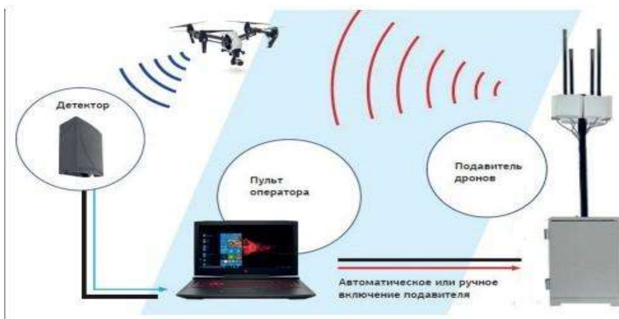
1-rasm (Dronlar harakatini aniqlovchi maxsus detektor qurilmasi)
