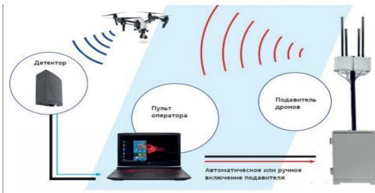
1-rasm (Dronlar harakatini aniqlovchi maxsus detektor qurilmasi)
